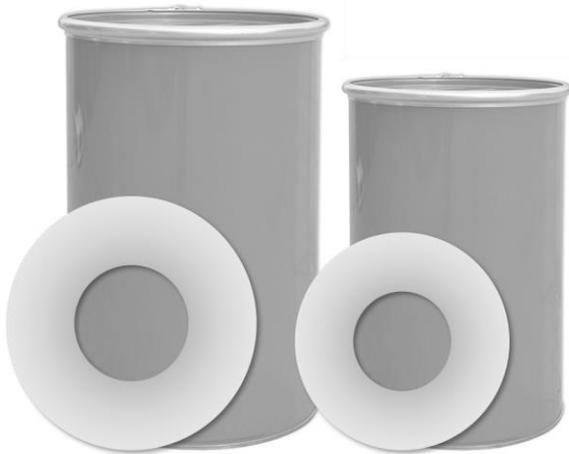
Gestanzte Ringe aus Polyethylen haben sich bei der Fass-Entleerung von hochviskosen Medien (Schmiermittel, Dichtmassen etc.) bereits millionenfach als kostengünstige Dichtungslösung bewährt. Als Einlage zwischen Medium und Presse, dichten die Scheiben zuverlässig gegen die Aussenwand hin ab, und ermöglichen so ein nahezu rückstandsfreies Abpumpen des Produkts. Gleichzeitig schützen diese Dichtscheiben die Press-Vorrichtung vor Verschmutzungen.
